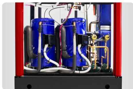
La gamma **EKW** adotta la soluzione multiscroll anche su singolo circuito, valvole di espansione a controllo elettronico, scambiatori di calore a piastre e la possibilità di gestire le pompe di circolazione (esterne) mediante il software dedicato: tutte queste caratteristiche consentono il raggiungimento di elevate efficienze energetiche ai carichi parziali.
