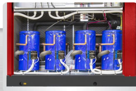
Le configurazioni disponibili per il circuito frigorifero sono studiate per garantire, anche contemporaneamente, ridondanza ed efficienza ai carichi parziali. In particolare, a seconda della taglia di macchina e della particolare esigenza impiantistica le unità sono costituite da due compressori su due circuiti per un'elevata ridondanza di sistema o da quattro compressori (doppio tandem) su due circuiti per un sistema al contempo ridondante ed efficiente ai carichi parziali.
