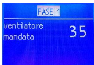
Si è all'interno del menù di taratura (vedi immagine a sinistra): in alto viene indicata la fase di taratura, sotto la linea vengono indicati i parametri da modificare (uno o più valori).
