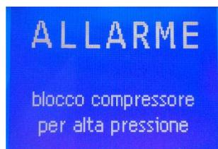
A sinistra un esempio di visualizzazione dell'allarme: in basso viene indicato il componente in allarme o il tipo di allarme; in questo esempio è in allarme il compressore per alta pressione. Questa schermata va comunicata all'Assistenza Tecnica in caso di allarmi
