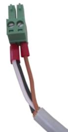
Se le polarità vengono invertite, il display non si accenderà. Le polarità sono indicate sia sulla scheda di potenza in plastica nera (bordo macchina) sia sul retro del display. Il cavo va collegato ai seguenti punti:
