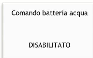
Possibilità di abilitare il comando acqua: in questo modo sarà possibile comandare una testina di zona o una valvola on/off o una piccola pompa acqua (massimo 1A). L'uscita funzionerà in riscaldamento in inverno e in raffreddamento in estate.
