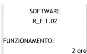
Questa schermata permette di visualizzare la versione software caricata e le ore di funzionamento, si entra in questa schermata solo dalla schermata principale tenendo premuto il tasto EXIT per 3 secondi, la schermata viene visualizzata per alcuni secondi e poi si torna in automatico alla schermata principale.
