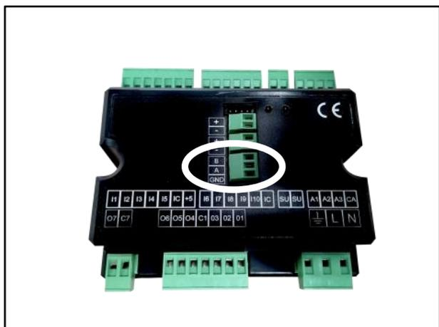
Utilizzare per il collegamento di tutta la rete Modbus un cavo CEAM Y08761 o equivalente.
