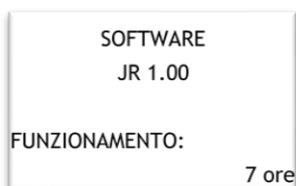
Questa schermata permette di visualizzare la versione software caricata e le ore di funzionamento, si entra in questa schermata solo dalla schermata principale tenendo premuto il tasto EXIT per 3 secondi, la schermata viene visualizzata per alcuni secondi e poi si torna automaticamente alla schermata principale.
