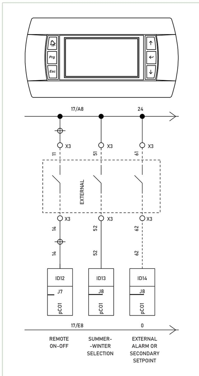
L'interfaccia utente pCO è composta da un display LCD e da 6 tasti. Essa permette di eseguire tutte le operazioni del programma, mostrare in ogni momento le condizioni dell'unità operante e modificarne i parametri di funzionamento.
