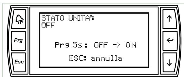
Tenere premuto per 5 secondi il tasto **PRG** per cambiare lo stato della macchina oppure premere il tasto **ESC** per uscire senza modificare lo stato.
