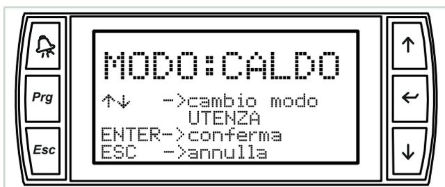
Utilizzare i tasti **UP** o **DOWN** per selezionare il nuovo stato; premere il tasto **ENTER** per confermare il nuovo stato oppure premere il tasto **ESC** per uscire senza modificare lo stato. La selezione da display locale o remoto permette di scegliere anche la modalità **OFF**, ossia di disabilitare l'utenza. In questo caso se la macchina è polivalente si avvierà solo per la produzione di acqua calda sanitaria.
